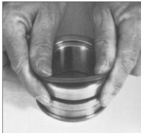
Ilust. 4.29 Montagem por deformação do anel de escorregamento em poliuretano
