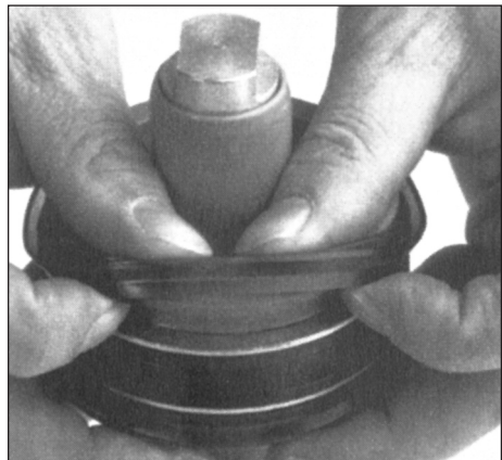
Ilust. 6.29 Ferramenta de montagem para gaxetas de êmbolo
