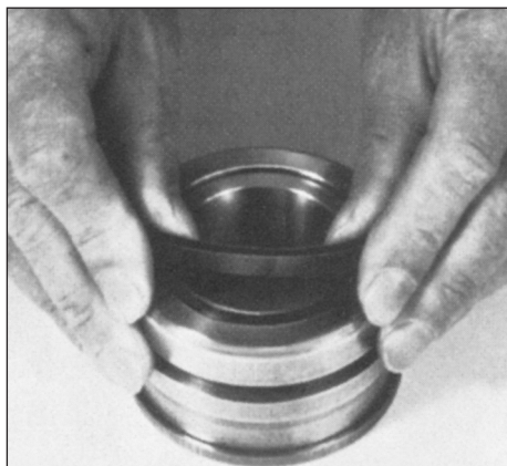
Ilust. 4.28 Montagem por deformação do anel afilador
