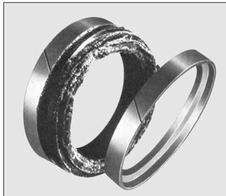
Ilust. 4.18 Extrusão numa gaxeta compacta de êmbolo
